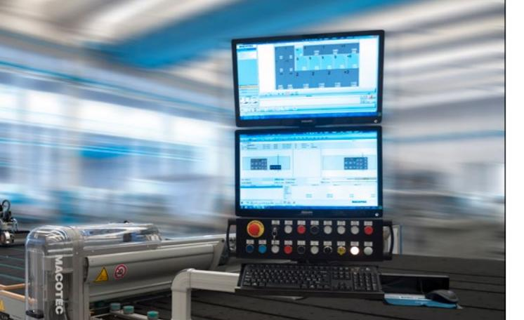
■ Linee combinate, ad elevata automazione per il taglio del vetro float e laminato, con tavolo di troncaggio posizionato a fine linea per ricevere lastre intere da poter essere troncate anche manualmente. Nella configurazione più avanzata, la linea prevede un gira pezzi per l'esecuzione automatica dei tagli XYZW, rifili minimi automatici fino a 2cm con scarico in cassone, movimentazione automatica dei vetri tagliati e troncaggio automatico dei traversi X (float).
