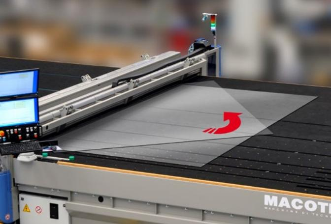
■ Dispositivo (brevettato) per la rotazione ed attestatura automatica delle traversi senza la necessità di intervento né consenso dell'operatore.
