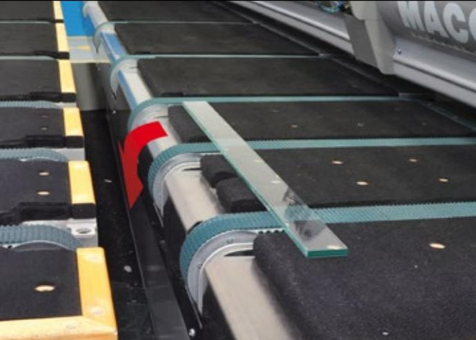
■ Vorrichtung zum Entfernen der Schutzfolie (TPF), angebracht auf der Glasoberfläche für Low-E-Schutzbeschichtung, entlang gerader und geformter Bahnen, vor der Randentschichtung. Extrem sauberes Verfahren ohne Verarbeitungsrückstände.
