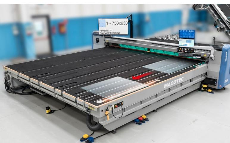
En présence de modèles de coupe avec débandage, ils sont gravés séquentiellement par la machine avant la rotation de la traverse. Les verres avec les débandages sont laissés horizontalement sur une résistance thermique supplémentaire, tandis que ceux déjà réalisés sont positionnés verticalement par la râtelier.
