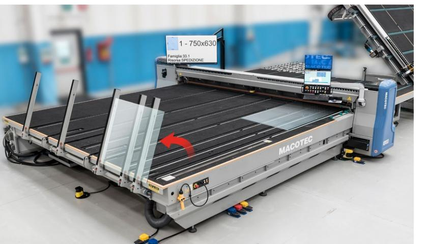
Ulteriori caratteristiche distinte di queste linee sono la possibilità di eseguire il taglio e l'apertura delle sagome curvilinee e di avere cicliche di taglio estremamente veloci, anche su alti spessori di vetro, grazie a premilastra movimentati da motori brushless controllati dal controllo numerico della macchina. La capacità produttiva di queste linee aumenta ulteriormente grazie alla possibilità di eseguire le incisioni sequenziali dei tagli di livello Z prima della rotazione del traverso.
