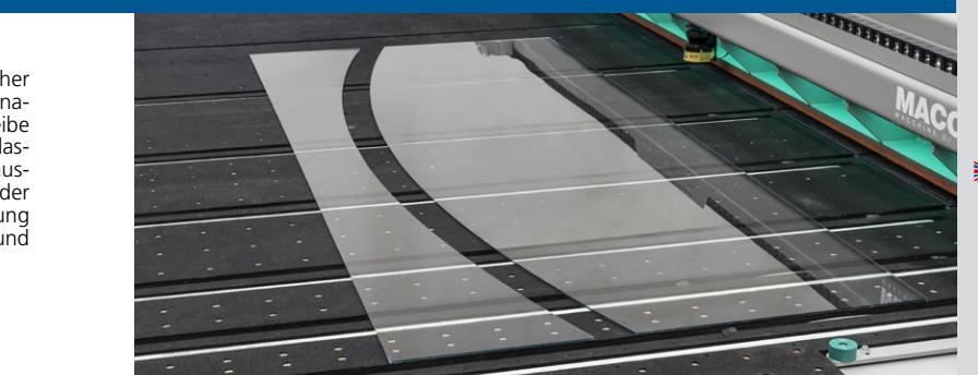
In presenza di schemi di taglio con rifiuti (tagli Z), gli stessi vengono eseguiti sequenzialmente dalla macchina prima della rotazione del traverso. I vetri con i rifiuti da separare, vengono lasciati in orizzontale su una resistenza aggiuntiva, mentre quelli già a misura vengono posizionati verticalmente dalla ribaltina.
