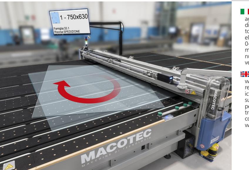
■ Pinza girapezzi automatica che, agendo in combinazione con i piedini di riscontro, permette di ruotare automaticamente traversi di dimensioni elevate e di alti spessori. Rotazione 0-360° della pinza eseguita da un motore brushless gestito dal controllo numerico per la massima affidabilità e velocità di esecuzione.
