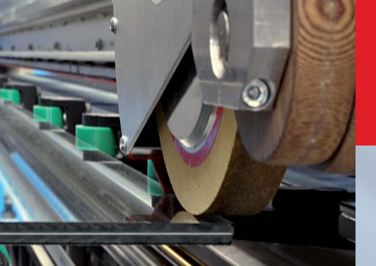
■ Tutti i modelli Active sono equipaggiabili con mola periferica per l'aspersione del rivestimento Low-E che può essere eseguita anche sul bordo lastra grazie all'attestatura a quota zero millimetri.
