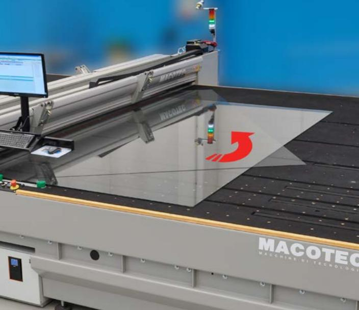
■ Dispositivo (brevettato) per la rotazione ed attestatura automatica dei traversi senza la necessità di intervento né consenso dell'operatore. Esecuzione automatica tagli W.
