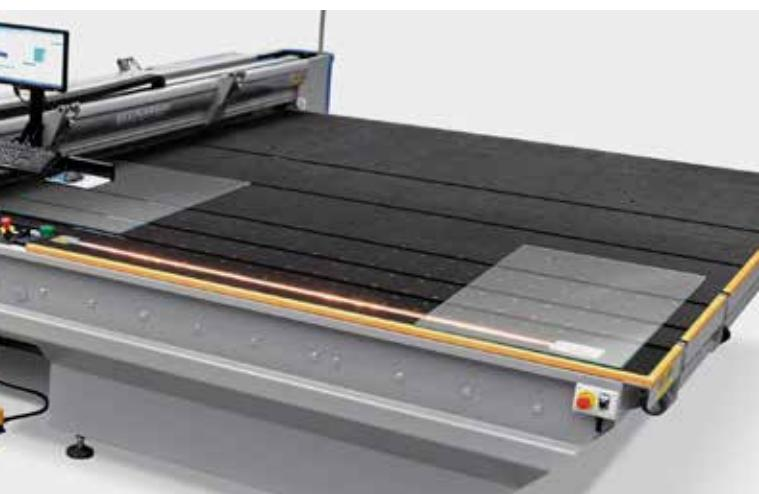
**PT** L'incisione dei tagli di livello Z (rifili) prima della rotazione del traverso, offre enormi benefici produttivi. È una funzionalità altamente innovativa che, processando la lastra di vetro laminato in modo del tutto nuovo, permette di raggiungere produttività elevate in presenza di piani di taglio complessi con un'elevata quantità di rifili.
