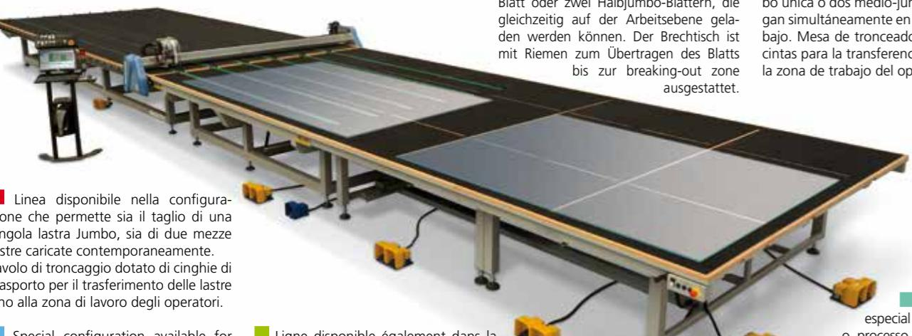
■ Linea disponibile nella configurazione che permette sia il taglio di una singola lastra jumbo, sia di due mezze lastre caricate contemporaneamente. Tavolo di troncaggio dotato di cinghie di trasporto per il trasferimento delle lastre fino alla zona di lavoro degli operatori.
