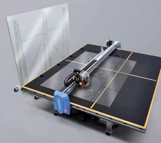
■ La lastra di vetro, posizionata sul cavalletto, viene automaticamente caricata dalle braccia, equipaggiate con ventose, e automaticamente trasportato sul piano di lavoro per l'inizio del ciclo di taglio.
