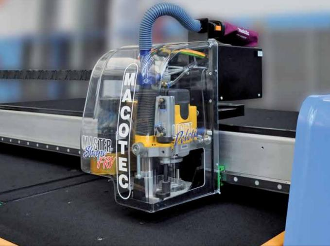
■ Testina da taglio completa di mola, azionata da un motore elettrico, per la rimozione del rivestimento Low-E. La polvere di molatura prodotta durante la lavorazione, viene aspirata e raccolta in un apposito filtro.
