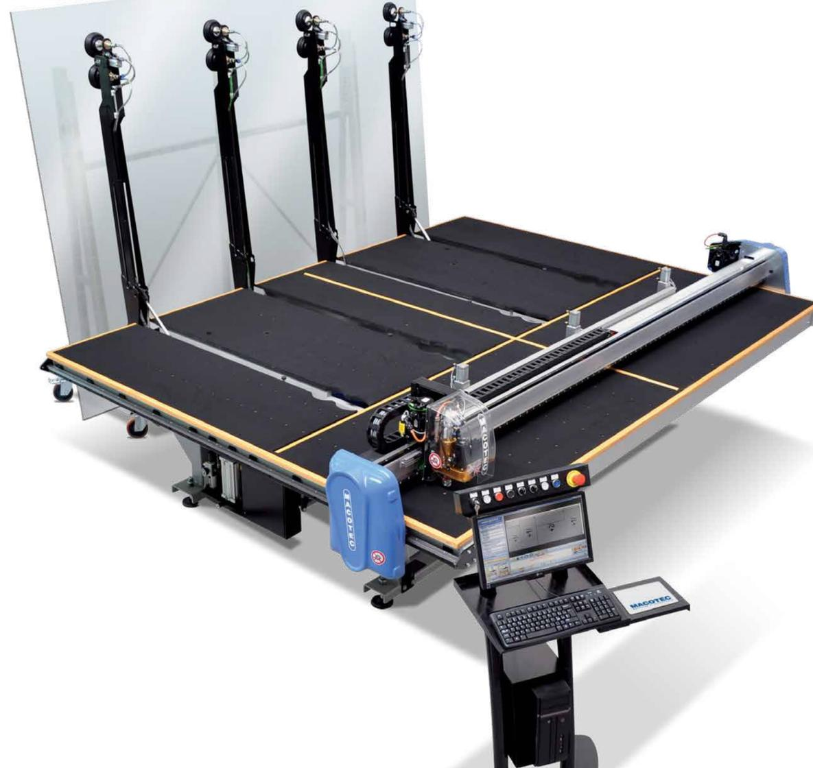
■ Selbstbeschickender Tisch zum zum Rechteck- und Formschnitt von monolithischem Glas. Leise, kompakt, schnell, genau, zuverlässig und flexibel. Das sind die Eigenschaften von Master Shape 3.7 FRV. Eine moderne und technologisch, fortgeschrittene Maschine mit oberen Saugern ausgestattet, zum automatischen Laden von Glasscheibe direkt von mobilen Rack.
