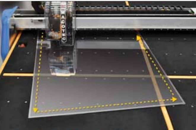
■ SquadratURA elettronica della lastra che non richiede alcun intervento manuale dell'operatore per il suo posizionamento. Il dispositivo consente l'esecuzione del taglio specolare per vetro laminato.
