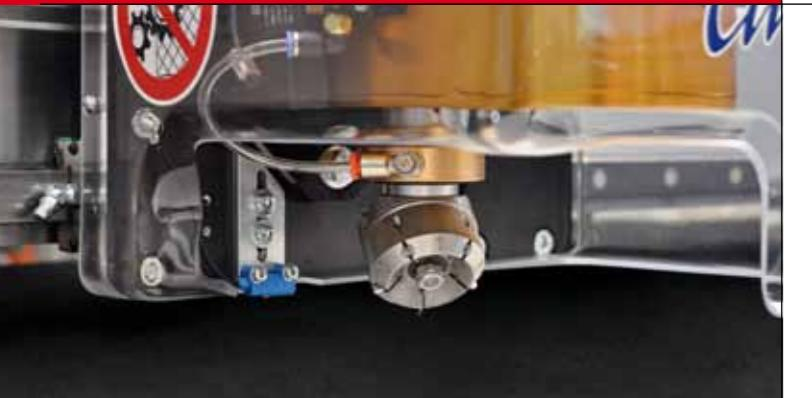
■ L'innovativo cambio utensile rotante "Click & Cut" permette di avere tutti gli utensili disponibili direttamente sulla testa di taglio: quando si cambia l'utensile, la sola rotazione del supporto multi-utensile è sufficiente per "parcheggiare" la rotella da sostituire e "posizionare" quella nuova sull'asse di taglio a tutto vantaggio della semplicità e del tempo ciclo. Disponibile con selezione dell'utensile manuale o automatica.
