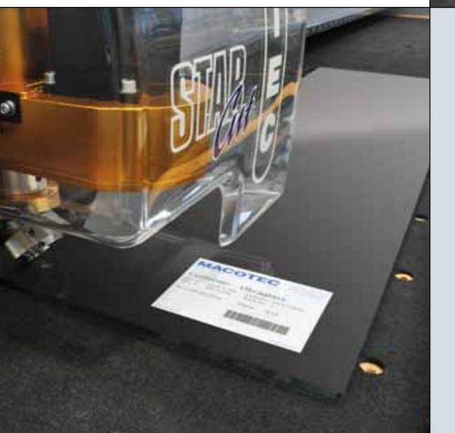
■ Rilevamento automatico di sagome con fori interni. Il profilo è ricostruito con precisione dal software. Si possono disporre sul piano più sagome per il rilievo in sequenza.
